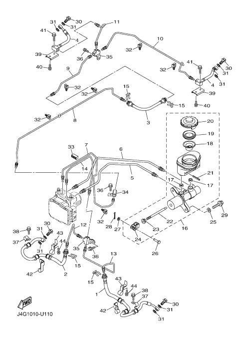
FIG. 9 FRONT MASTER CYLINDER
