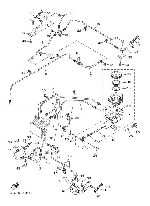
FIG. 9 FRONT MASTER CYLINDER
