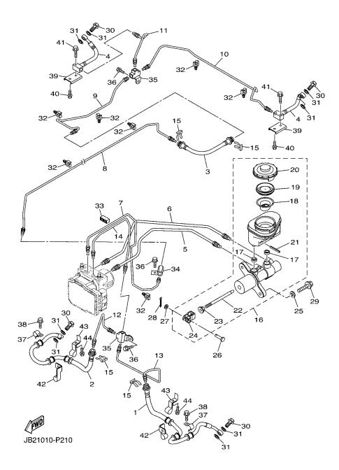
FIG. 9 FRONT MASTER CYLINDER
