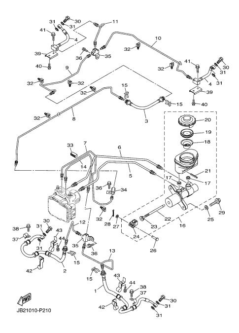
FIG. 9 FRONT MASTER CYLINDER
