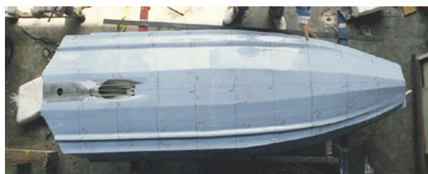
図7 タンデムモデル試作艇の船底形状
