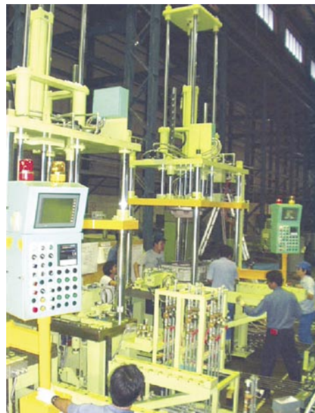
図3 キャストホイール用重力鑄造機 (インドネシア現地メーカーにて製作)
