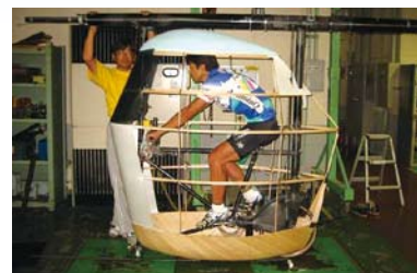
図6 操縦席のカーボンフレーム構造
