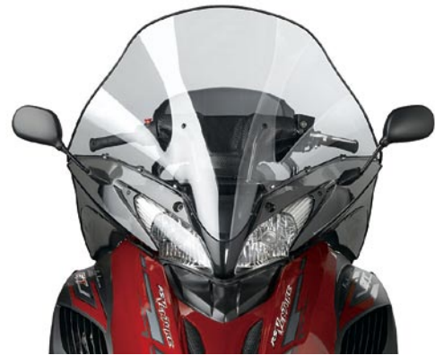
図9 分割構成のウィンドスクリーン
