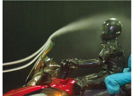
図8 ウィンドプロテクション実験風景
