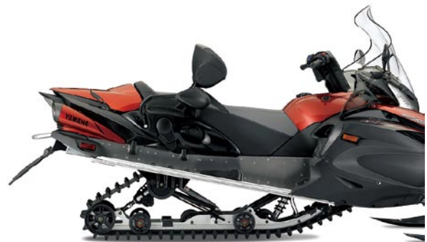
図10 ライダーサポート状態のバックレスト
