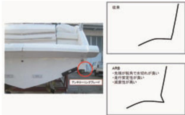
図5 EXULT36 アンチローリングブレード
