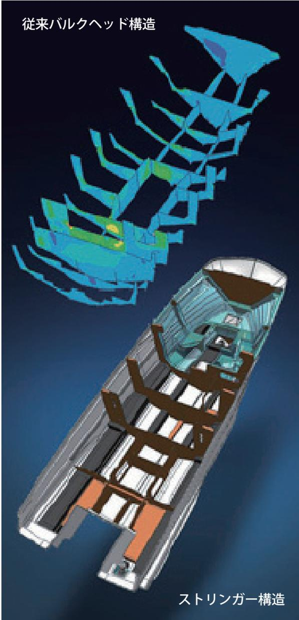
図 13 S-QUALO ストリンガー構造
